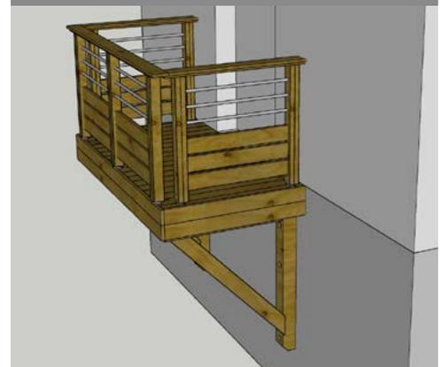
**Structure** en pin traité autoclave classe IV.
